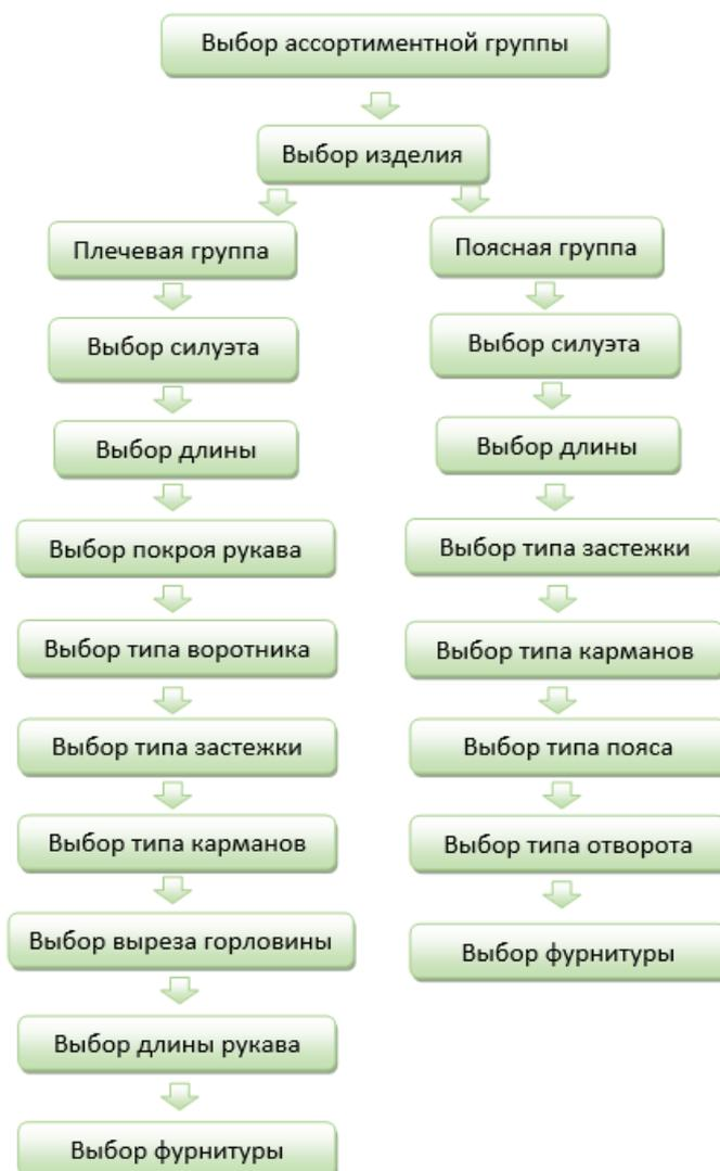
Рисунок 2.6 – Алгоритм сбора модели одежды
