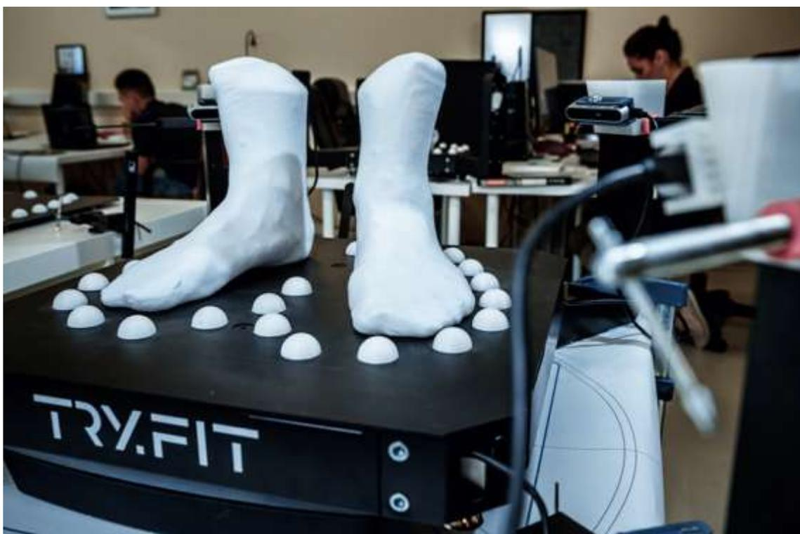
**Рисунок 1.7 – Фотоизображение сканера TRY.FIT**
