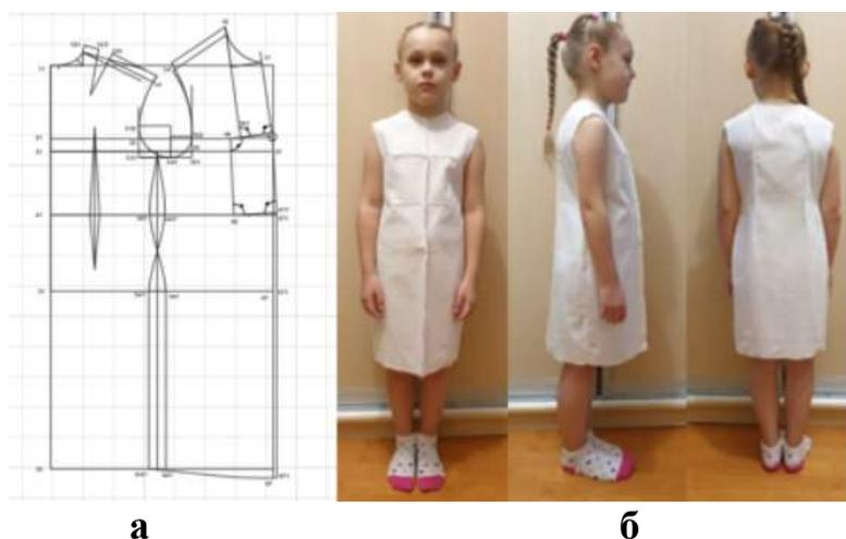
**Рисунок 3.13 – Экспериментальный образец № 5: а) схема чертежа конструкции; б) макета детского платья полуприлегающего силуэта**
